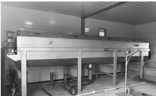
图 3 二级固液分离系统现场图
