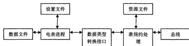
图2 终端下行通信过程
