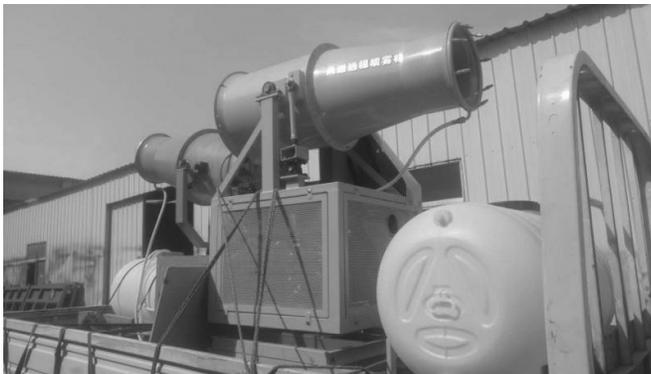
图2 “大炮式”降尘喷雾设备
