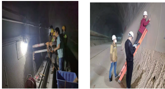
图9 钻芯法检测(左)冲击弹性波检测(右)
