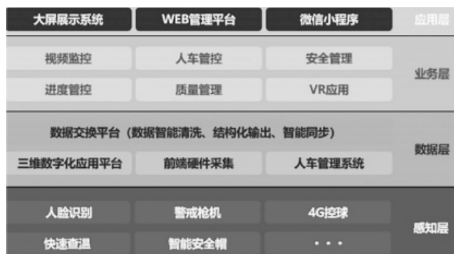
图 1 变电站智慧管理平台子系统组成
